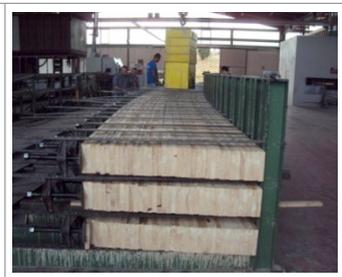
**Figura 2.21.** *Particolare pressatura trave curva*
