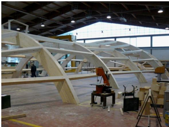
**Figura 2.24.** *Pre-assemblaggio in stabilimento di una struttura ad archi*
