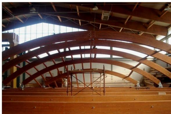
**Figura 2.23.** *Pre-assemblaggio in stabilimento di una struttura ad archi*
