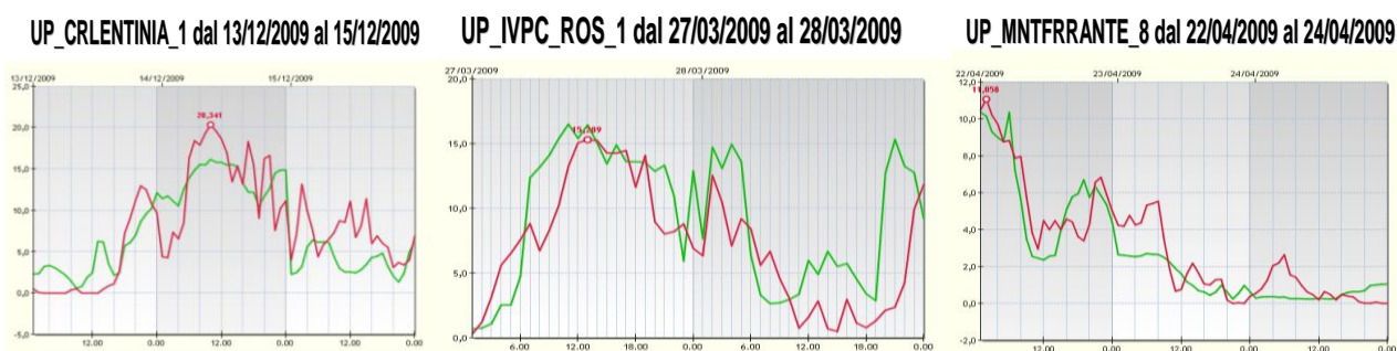
Fig. 7.10: Esempi di confronti fra energia misurata (curva rossa) e energia prevista (curva verde)
