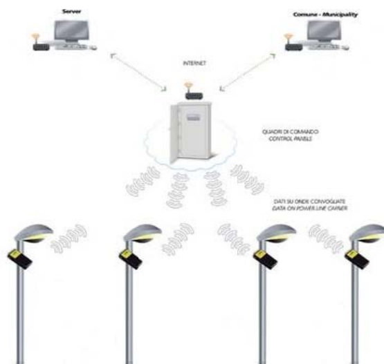
Figura 6.27: Sistema di telecontrollo e gestione energetica
