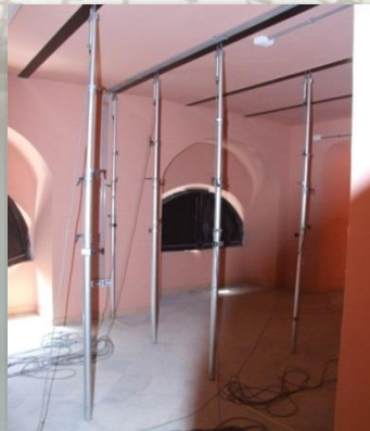
PROVE DI CARICO SUI SOLAI LIGNEI
