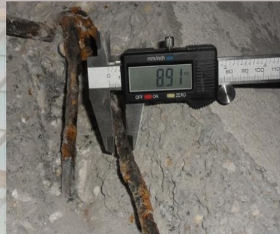
RILIEVO DIRETTO DELLE BARRE D'ARMATURA
