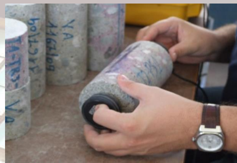
VERIFICA DELL'OMOGENEITA' DEL CALCESTRUZZO
