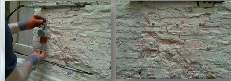
MARTINETTI PIATTI DOPPI (DETERMINAZIONE DELLE CARATTERISTICHE MECCANICHE)
