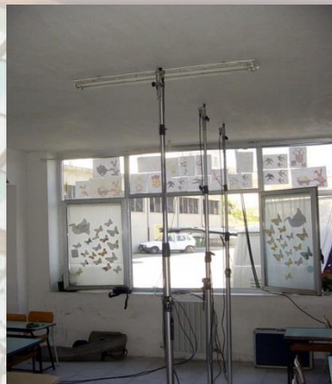
Prove di carico su solaio
