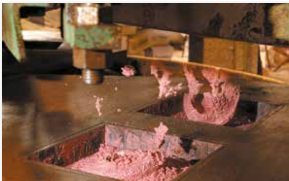
1. Versamento dell'impasto/Batch out mixture
