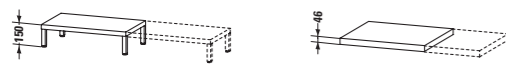
# 8601 \nearrow 365 mm # 8603 \nearrow 550 mm (<1201 mm 4 piedini) # 8602 \nearrow 365 mm # 8604 \nearrow 550 mm (>1200 mm 6 piedini) # 066 C \nearrow 365 mm # 067 C \nearrow 550 mm
