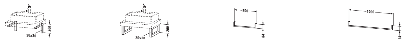
# 9927 ↔ 425 mm, ↗ 30 mm Staffa di sostegno # 9928 ↔ 480 mm, ↗ 30 mm Staffa di sostegno - portasciugamani # 9985 ↗ 14 mm # 9986 ↗ 14 mm
