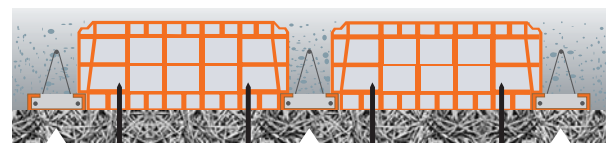
Solaio in laterocemento rivestito con pannelli Celenit fissati con tasselli ad espansione
