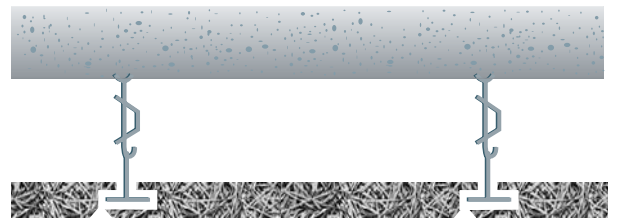
Pannelli a bordi smussati montati su profili a scomparsa con pannelli mobili
