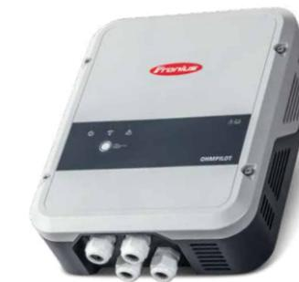
/ È un dispositivo nato per offrire all'utente facili soluzioni di autoconsumo, utilizzando l'energia solare per abbattere i consumi termici dell'abitazione. Dialogando senza fili con la scheda Datamanager 2.0 e lo Smart Meter Fronius, può impiegare il surplus di energia per alimentare carichi puramente resistivi presenti nell'abitazione. La regolazione della potenza è continua e personalizzabile (da 0 a 9 kW).
