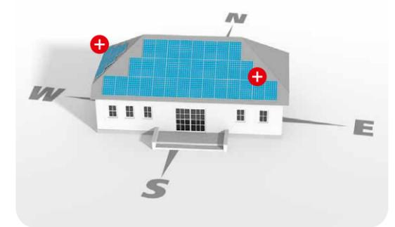
/ Configurazione asimmetrica con grande sbilanciamento di tensione e potenza sui 2 inseguitori
