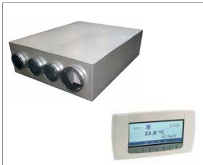
Fig. 5-5 ENTALPICO Ideale per climi freddi permette di recuperare l'energia sensibile e latente dall'aria senza trasferire vapori e odori. Scambiatore in membrana polimerica permeabile con rivestimento in Microban che previene la formazione di muffe e batteri (non è necessario lo scarico condensa)
