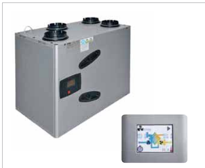
Fig. 5-4 ENTALPICO Ideale per climi freddi, permette di recuperare l'energia sensibile e latente dall'aria senza trasferire vapori e odori. Scambiatore in membrana polimerica permeabile con rivestimento in Microban che previene la formazione di muffe e batteri (non è necessario lo scarico condensa).
